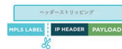
ツールがサポートしないプロトコルを検知し、ヘッダ部分を削除
