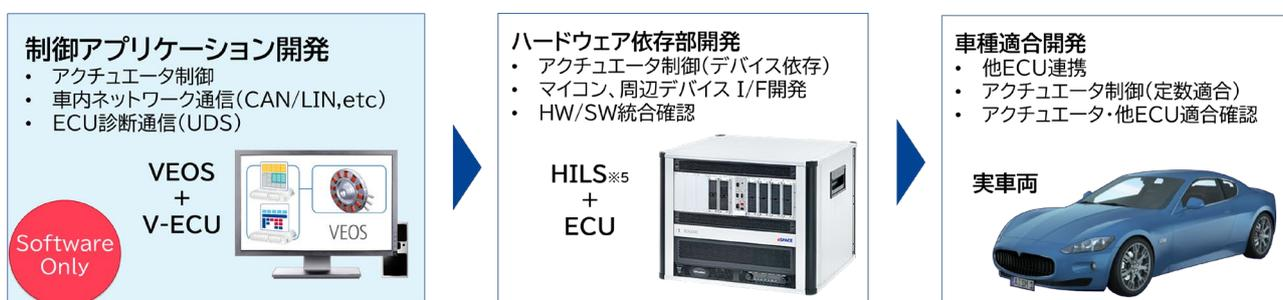
※5 Hardware in the Loop Simulation の略で ECU 上のソフトウェアとハードウェアとの統合検証
